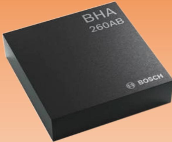
Bosch BHA260AB 超低功耗智能传感器具有 1.8V 工作电压、<1 秒校准时间以及多达 12 个 GPIO。BHA260AB 包含 Bosch Sensortec 的可编程 32 位微控制器 (Fuser2)、三轴加速度计以及功能强大的软件框架。Fuser2 Core 能够在 20MHz (Long Run 模式) 和 50MHz (Turbo 模式) 下工作。Bosch BHA260AB 超低功耗智能传感器是超低功耗常开传感器处理的理想解决方案。
