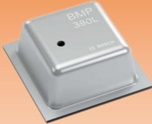
Bosch BMP390L 高性能长寿命大气压力传感器的寿命长达 10 年，设计用于工业用途，包括机器人、家用电器、物流以及其他需要长寿命、高性能和低功耗的设计。Bosch BMP390L 大气压力传感器具有高精度，测量范围为 300hPa 至 1250hPa。该传感器具有中断功能，可以对数据和存储进行简单访问。它还具有 FIFO 功能，提高了易用性，同时有助于在整个运行过程中降低功耗。BMP390L 采用 10 引脚 2.0mm x 2.0mm x 0.75mm<sup>3</sup> LGA 封装（带金属盖）。
