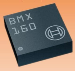
BMX160 能够适应严苛的空间限制/这种微小的节能 9 轴 Bosch Sensortec 传感器可以为可穿戴应用(如智能眼镜)BMX160 安装于紧凑的 2.5 x 3.0 x 0.95 mm3 封装中,是行业内最小型的 9 轴运动传感器。可实现智能腕表的手势控制、计步器、磁航向和设备导航功能。与 BMI160 的引脚和寄存器兼容,超低功耗有助于延长电池的充电间隔,相比于智能手机,穿戴式设备面临更加严苛的空间和功耗限制。BMX160 节能 9 轴传感器为这类使用环境提供了一种理想的解决方案。
