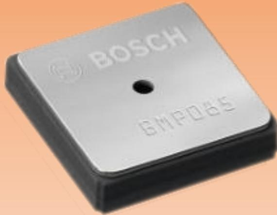
BMP085 是一款高精度、超低功耗的大气压力传感器，非常适合应用于移动设备中，比如：手机，PDA，GPS 导航设备和户外运动设备。可以通过 IIC 总线直接与各种微处理器相连。
